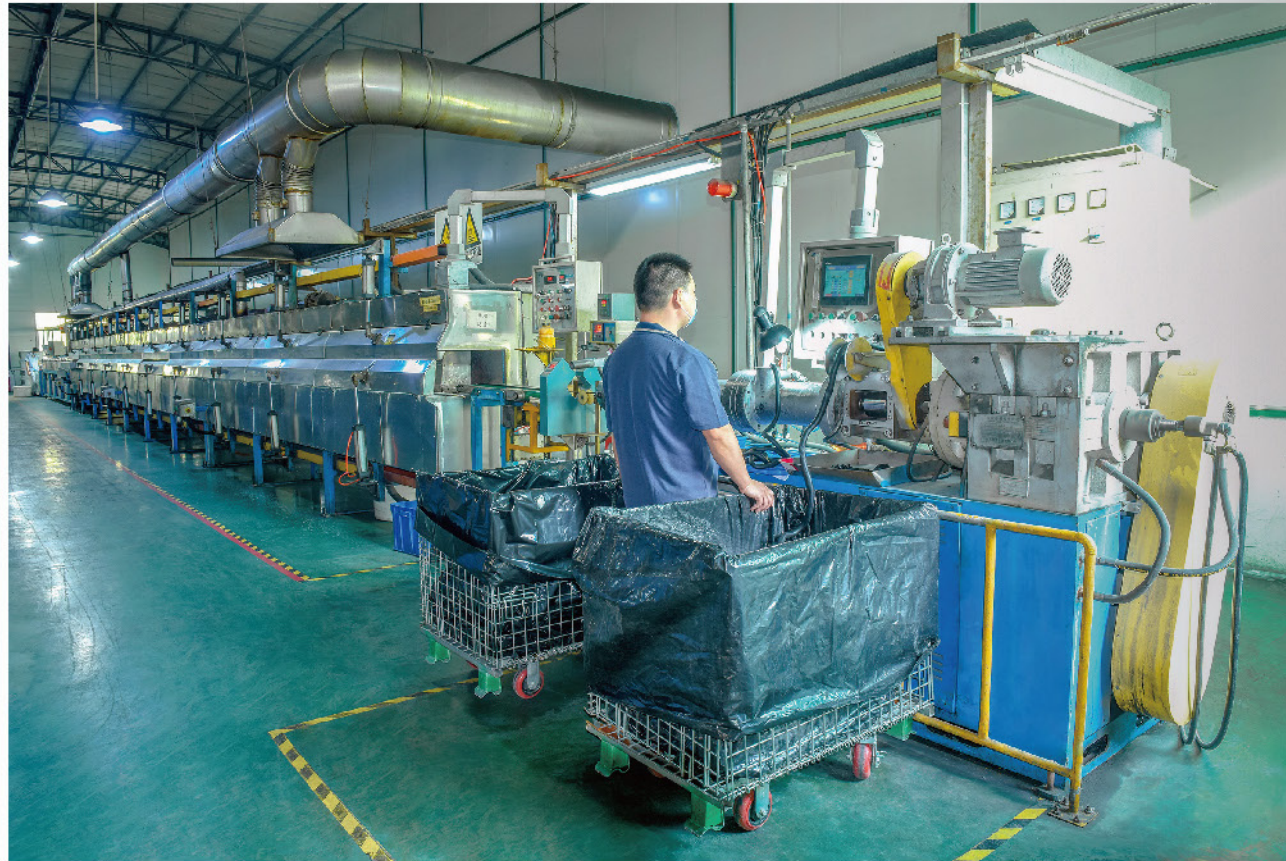
套管車間-鹽浴套管生產線
