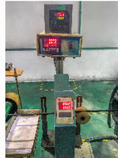
套管車間-紅外自動測內徑機
