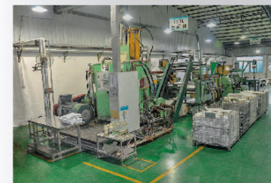
海綿車間-海綿B煉生產線(110吋車機&250吋出機&22吋剪機)
