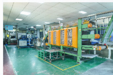
B煉車間-膠片冷卻和收料系統
