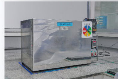
实验设备-紫外线测试仪
