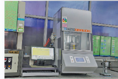
实验设备-MV-3000A-U 目尼黏度仪
