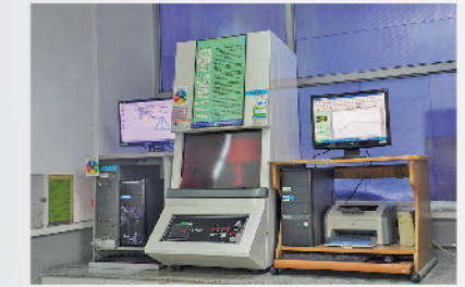
实验设备-EKT-2000SP无转子硫变仪
